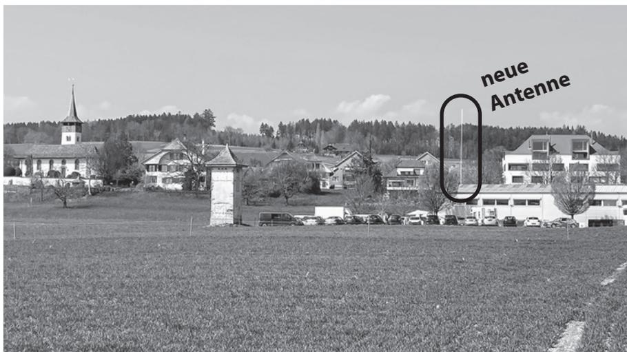
Geplanter Standort der neuen 20 m hohen Mobilfunkantenne auf der Nord-west-Seite des Industriegebäudes.
