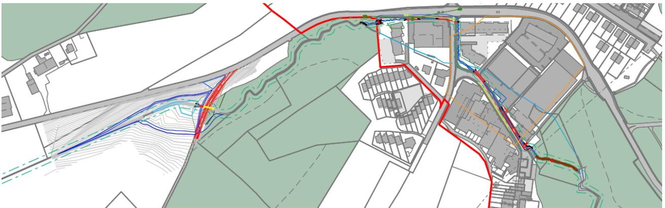
Der Glasbach wird vor dem Siedlungsgebiet der Uettligenstrasse entlang bis zur Einmündung der Dettigenstrasse geführt. Weiter wird der Glasbach entlang der Dettigenstrasse und dem Mettlenwaldweg (im Bereich der heutigen Parkfelder beim Tenniscenter) bis zum bestehenden Auslaufbauwerk unterhalb der Tennishallen offen geführt und renaturiert.
