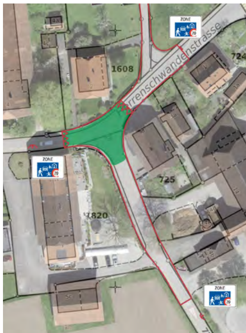
Projektskizze für mögliche bauliche Lösung Knoten Herrenschwandenstrasse / Halegasse (Variante 1)
