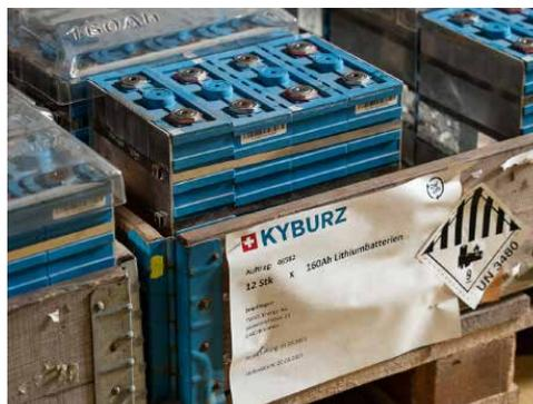
Second Life Batterien können als Speicher verwendet werden ([modual.ch/de/second-life-batteries](http://modual.ch/de/second-life-batteries)).
